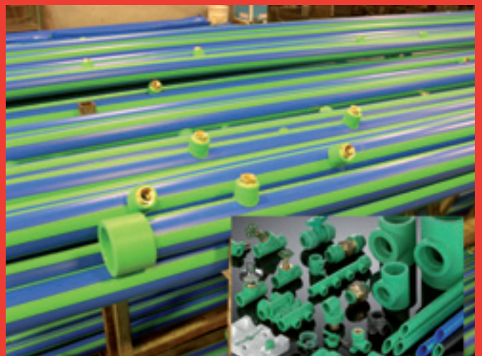
Kunststofleidingssystemen: vervaardiging in atelier en op werven Système de tuyauterie PPR: préfabrication à l'atelier et sur chantiers
