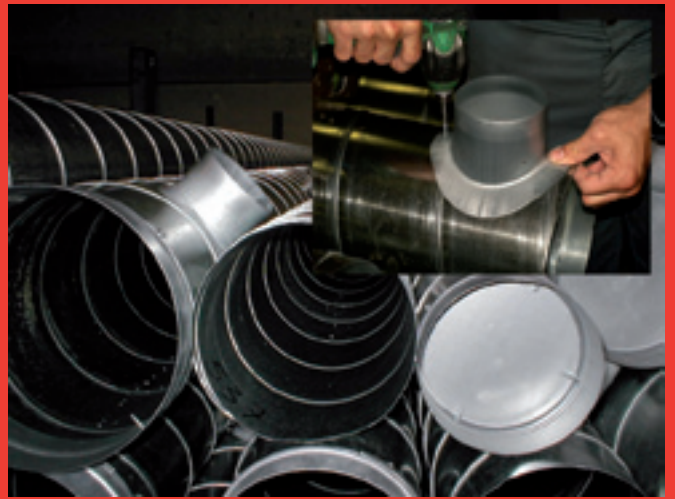
Prefab van luchtkanalen Préfabrication de canalisations d'air
